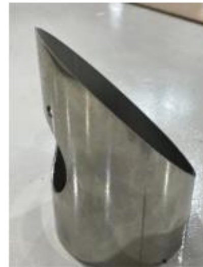
レーザー加工したパイプ
