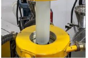
【フィルム化】 製膜機によるフィルム化。 温度最適化により、異物発生を抑制し、リサイクル樹脂のフィルムが完成。
