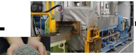
【混合・混練】 混練工程でレーザーフィルターにかけて、異物を除去。 相溶化剤を添加し混合し細かくし、その後、ペレットにする。
